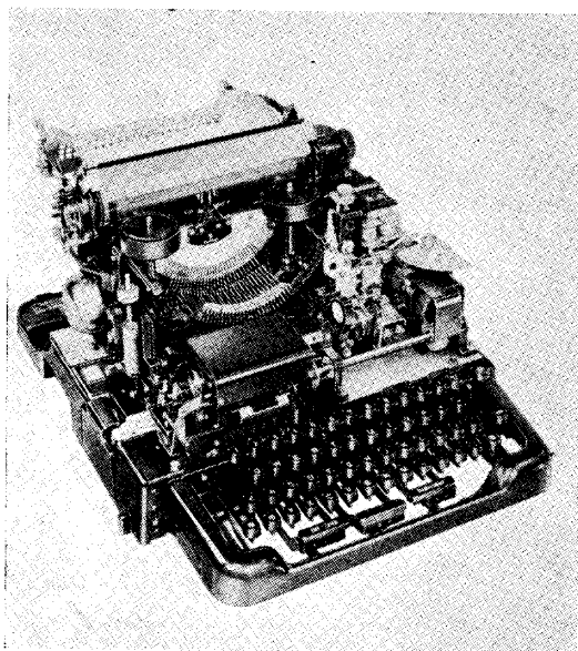
Fig. 4. Het inwendige van de Siemens verreschrijver T-37
